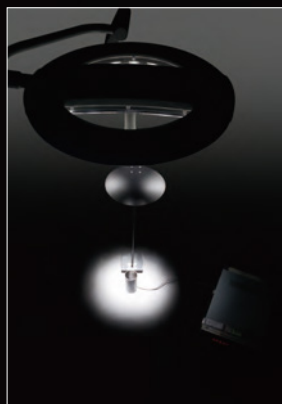
Eliminación de las sombras con un tubo y una máscara 70%
